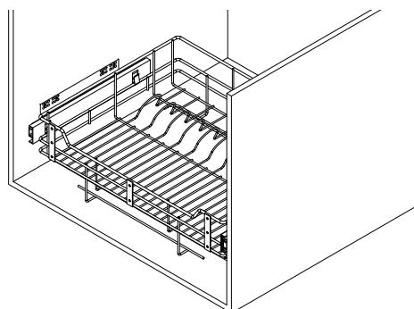
Si es necesario ajustar la canasta al módulo, dilate los tornillos de la platina con ayuda de un destornillador hasta acomodarla.
