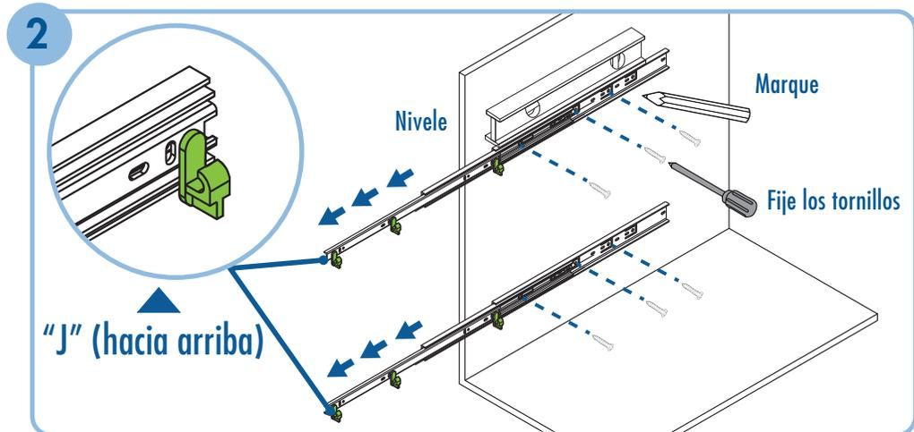
Expanda por completo los rieles hacia afuera y verifique que las "J" estén igual a la posición señalada en el gráfico, de ser necesario gírelas. Con ayuda de un destornillador, fije los rieles al módulo en los puntos marcados.
