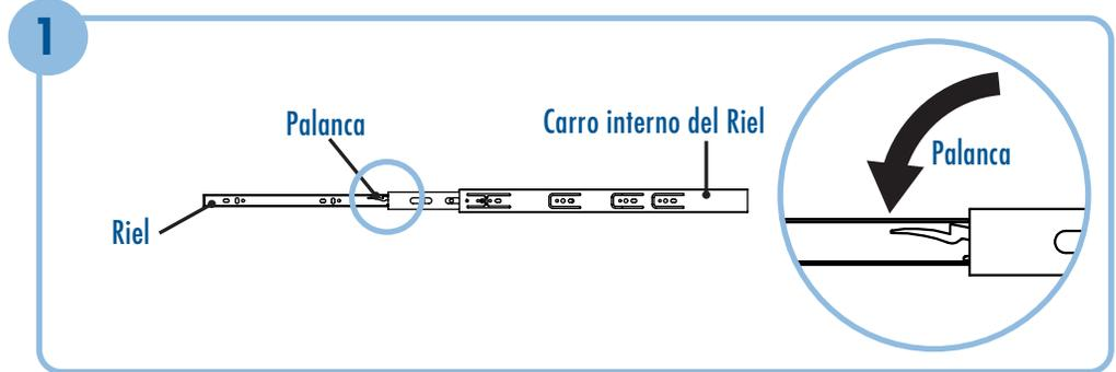
Tome un Riel y despléguelo por completo e identifique la Palanca como se muestra en la imagen. Presione la Palanca y retire el Carro interno del riel halándolo hacia afuera.
