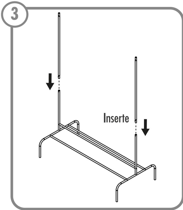
Inserte los Laterales con pin en los tubos de las Bases laterales hasta hacer clic.
