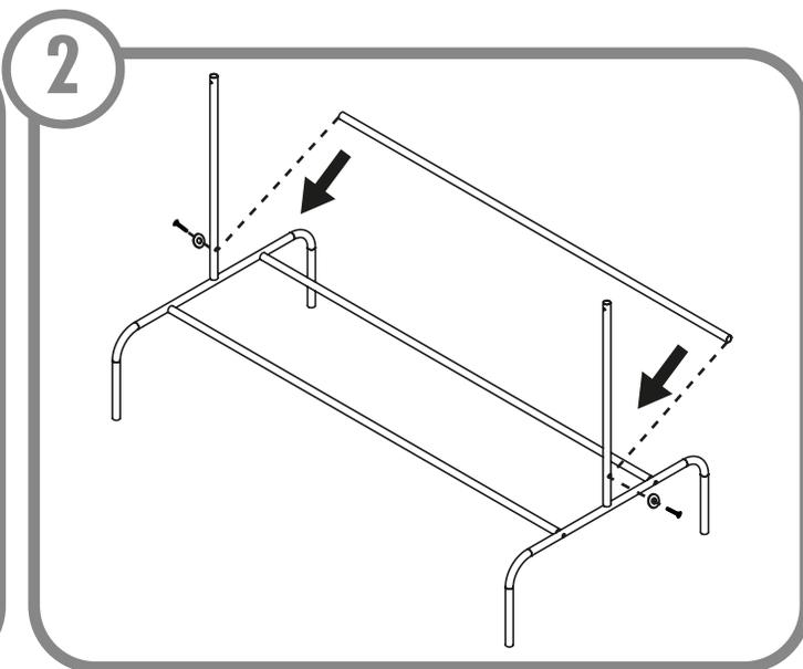
Inserte un Travesaño entre las Bases laterales, y fíjelo con Arandelas y Tornillos.
