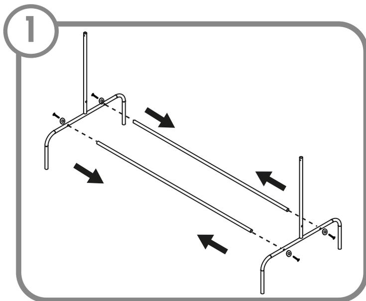
Con la ayuda de un destornillador, fije las 2 Bases laterales con 2 Travesaños, 4 Arandelas y 4 Tornillos, como se indica en el gráfico.
