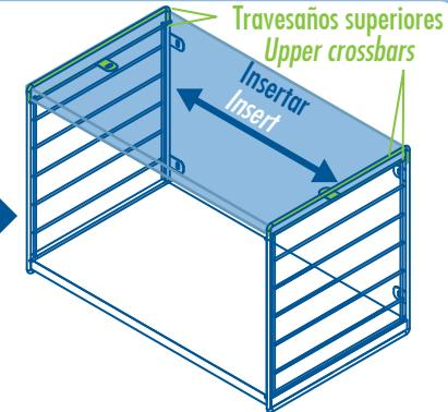
Inserte un Entrepáño en madera entre los dos travesaños inferiores de los Marcos y utilícelo para medir el ancho entre ambos Marcos. Nivele y marque los puntos a perforar para fijar con Chazos y Tornillos, el segundo Marco.
