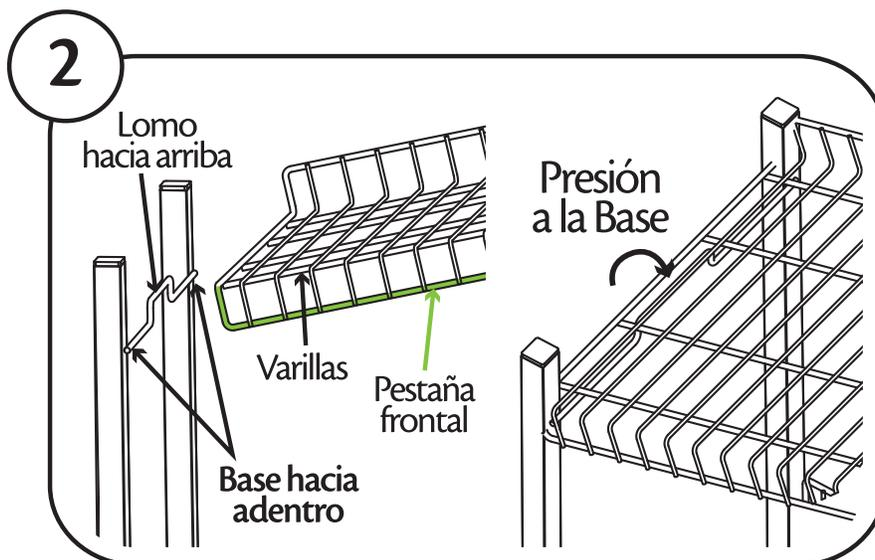
Ubique los Laterales con las **Bases** hacia adentro y los **Lomos** hacia arriba. Comience insertando en los **Laterales inferiores** un **Entrepaño** (debe tener la pestaña frontal hacia abajo y las varillas por debajo, como se muestra en el gráfico). Haga presión en la Base para insertar el Entrepaño. Repita este paso con el resto de Entrepaños en cada una de las Bases de los Laterales.
