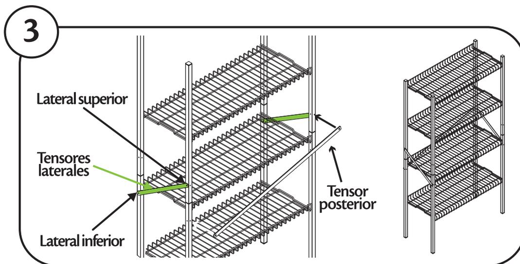
Asegure los **Tensores laterales** de la siguiente manera: Ubique un lateral del clóset y fije con **Tornillos** un **Tensor lateral** en el orificio del **Lateral inferior**, luego fije en el orificio del **Lateral superior**, quedando instalado de manera diagonal. Repita este paso en el otro lateral del clóset con el Tensor lateral restante.
