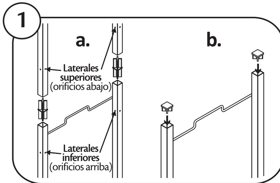
**a.** Inserte las Unión paral en la parte superior de los Laterales inferiores (orificios hacia arriba). Luego encaje los Laterales superiores (orificios hacia abajo) en las Uniones paral.
